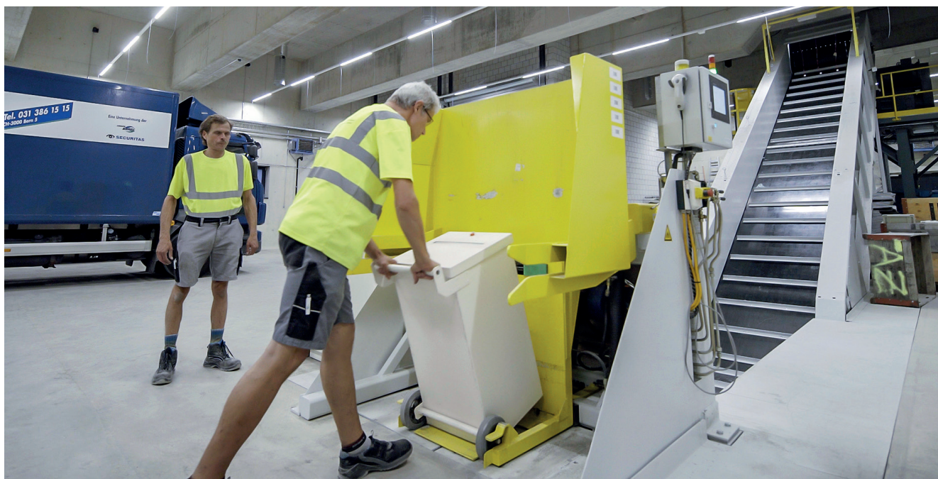
Déchargement dans des écluses et broyeurs sécurisés des documents et supports de données électroniques confidentiels
